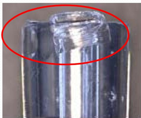
フィルター上部のメスコネクターが破損
